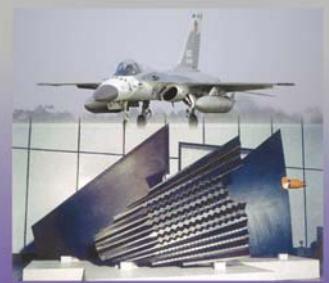
IDF及IDF水平尾翼內部複材浪板結構件
