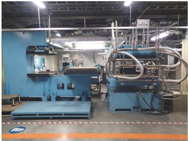
樹脂灌注成型(RTM)設備
