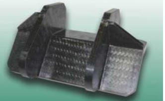
代設備昂貴且高耗能的傳統熱壓爐製程。漢翔公司已建立00A製程之樹脂灌注成型(RTM)技術及設備，研發的產品，包括機身窗框、傳力接頭及引擎葉片等。RTM製程技術重點在模具設計、預成形物製作、樹脂特性等。
