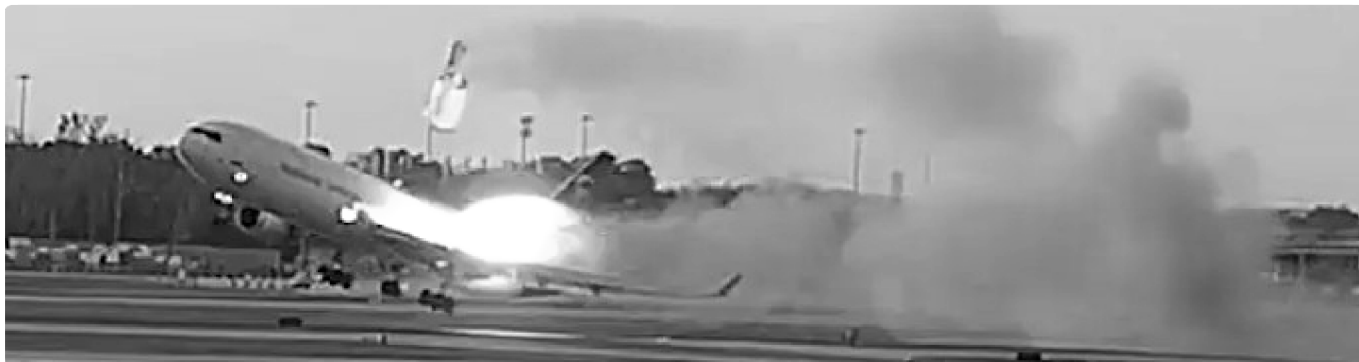
圖片來源NTSB，機場監視器影片的靜態畫面顯示，左側發動機及左側支柱（pylon）正與左側機翼分離。
