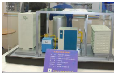
沼氣微型發電機
